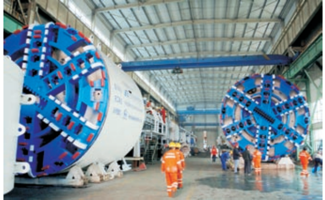
中铁隧道装备制造公司生产的中国中铁三号、四号盾构机
